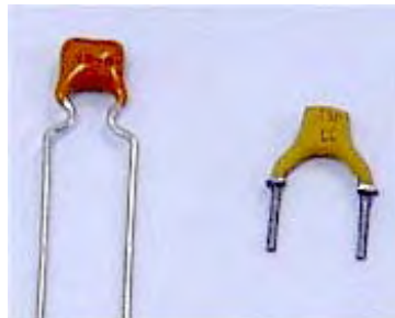
Fig. 4.5 - Condensadores cerâmicos (esquerda 100nF, direita15pF)
