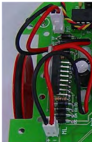
Fig. 4.41- Encaixe dos terminais dos motores
