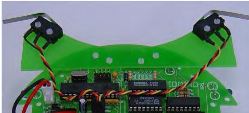
Fig. 4.44 - Exemplo de montagem dos sensores de contacto.
