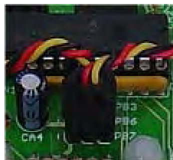
Fig. 4.46 - Montagem dos terminais dos sensores de contacto na placa.
