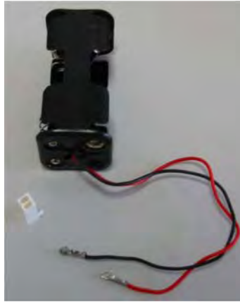
4.36- Montagem do suporte de Pilhas
