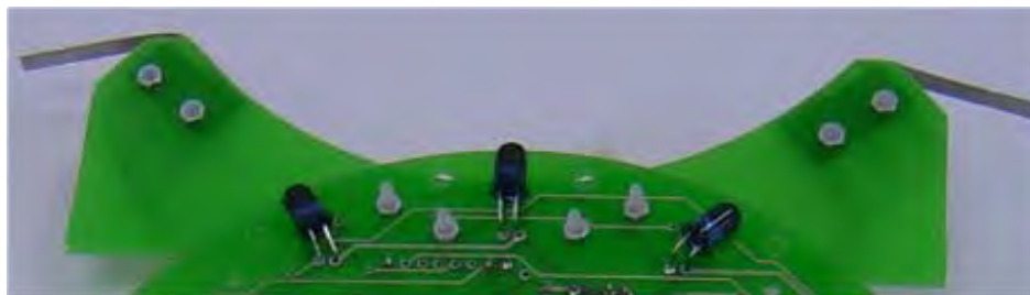
Fig. 4.45 - Exemplo de montagem dos sensores de contacto.
