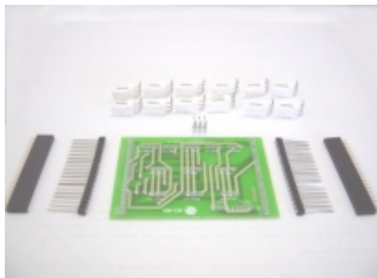
Fig. 4.9 - Material utilizado na construção da placa ID-DS002
