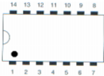
Fig. 4.5 - Formato de um circuito integrado do tipo DIP
