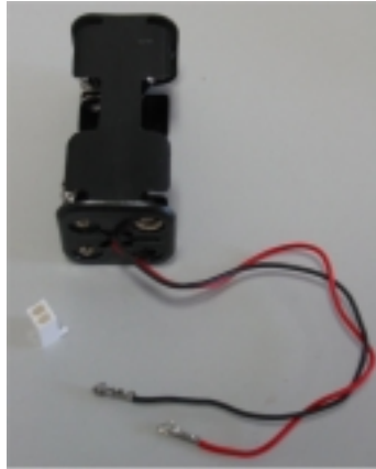
Fig. 4.14 - Suporte de pilhas
